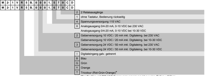
\*Bei Geräten mit 230 VAC Spannungsversorgung ist nur eine Option wählbar: Relaisausgänge, Analogausgang oder Geberversorgung.
